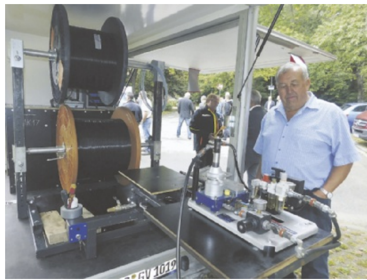
Foto links: Franz Honold, Bauleiter bei der Firma Georg Vetter aus Hüfingen, zeigt einen Schaltkasten für Glasfaser in Achdorf. Foto rechts: Franz Honold zeigt Technik, mit der Glasfaser bis zu den Häusern in die Leerrohre eingeblasen wird. Fotos: Eric Zerm
